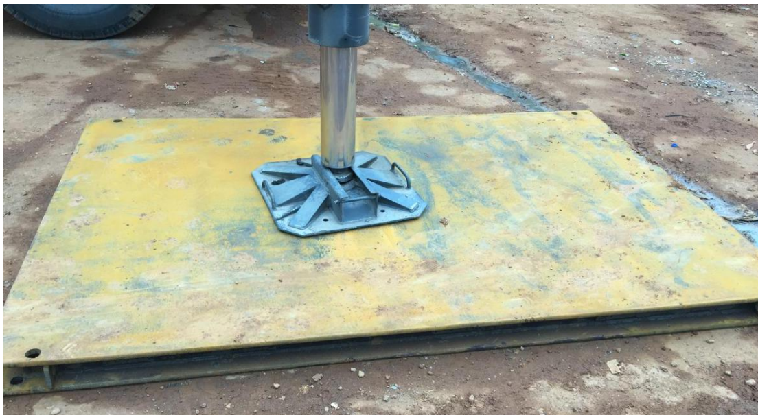
图 6.4.1 汽车式起重机支腿垫板示意图
