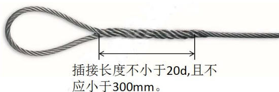
图 6.1-1 钢丝绳编插接头示意图
