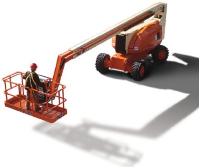
图 3.18.3-2 自行走直壁式高处作业平台
