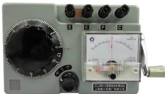
图 9.3-2 摇表电阻测试仪
